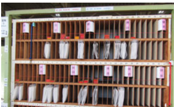
差立てに受注伝票と赤色のチッキを積んで負荷状況が見える化。生産能力の限界を示す赤線をチッキが超過する際には、前倒し対応として黄色のチッキとして別日等に振り分けるなどし、担当社員が各々負荷、納期を管理している。
