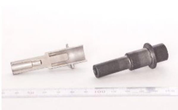
冷間鍛造で製造された電子燃料噴射装置の部品となるハウジング。内部の空洞部分も鍛造により成形している。
