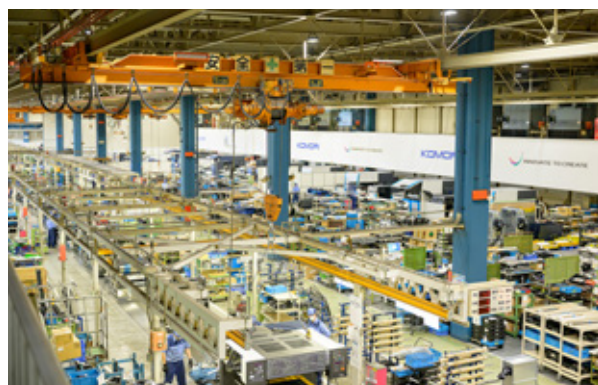
印刷機がユニットごとに組み立てられる「本機ライン」の様子
